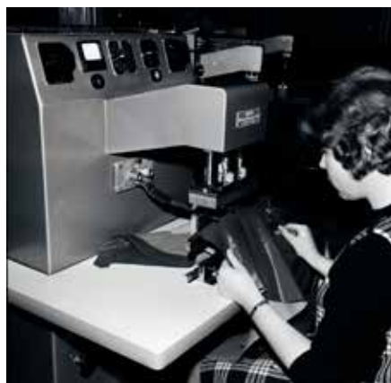
Didriksons var tidigt ute och svetsade sömmarna i sina regnkläder för att få dem helt täta.
